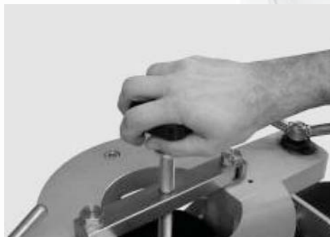
13. Upínací trn dotáhnout rukou a nepřilíš velkou silou .
