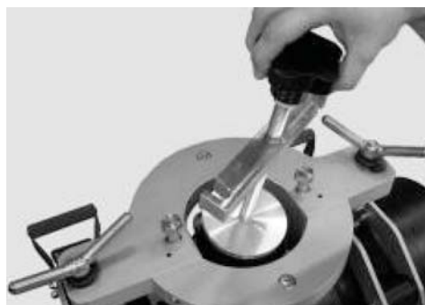
9. Nasadit upínací trn s přítlačným talířem, který odpovídá dimenzi vývodu ze sedlové elektrotvarovky (90 mm/110 mm/125 mm)
